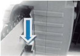
El recoge cadenas sirve para coger una cadena de sierra rota o que se haya salido de la guía. Mediante el mantenimiento regular del riel de la sierra y el tensado correcto y regular de la cadena de la sierra, se pueden prevenir accidentes de este tipo.
